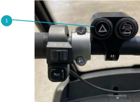
Abb. 25: Schalter für Warnblinker
