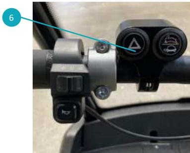
Abb. 20: Betätigung des Manövriermodus (Schiebehilfe)
